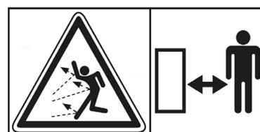
No trabaje con la desbrozadora sobre grava o cuerpos extraños que pueden ser lanzados incluso a distancia y son muy peligrosos. Mantenga a las personas a una distancia mínima de 15 m cuando la máquina esté en funcionamiento.
