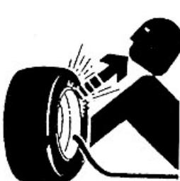
La separazione fra pneumatico e cerchione, causata dall'esplosione del pneumatico, può provocare serie ferite o addirittura la morte.
