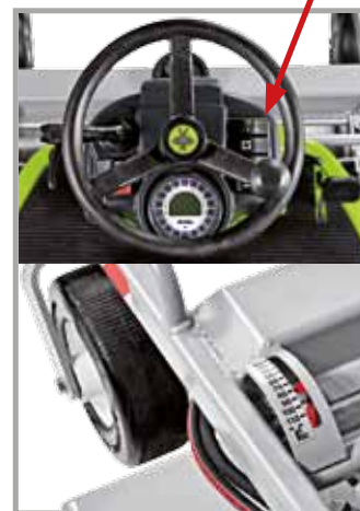
Regulación altura de corte continua e hidráulica
