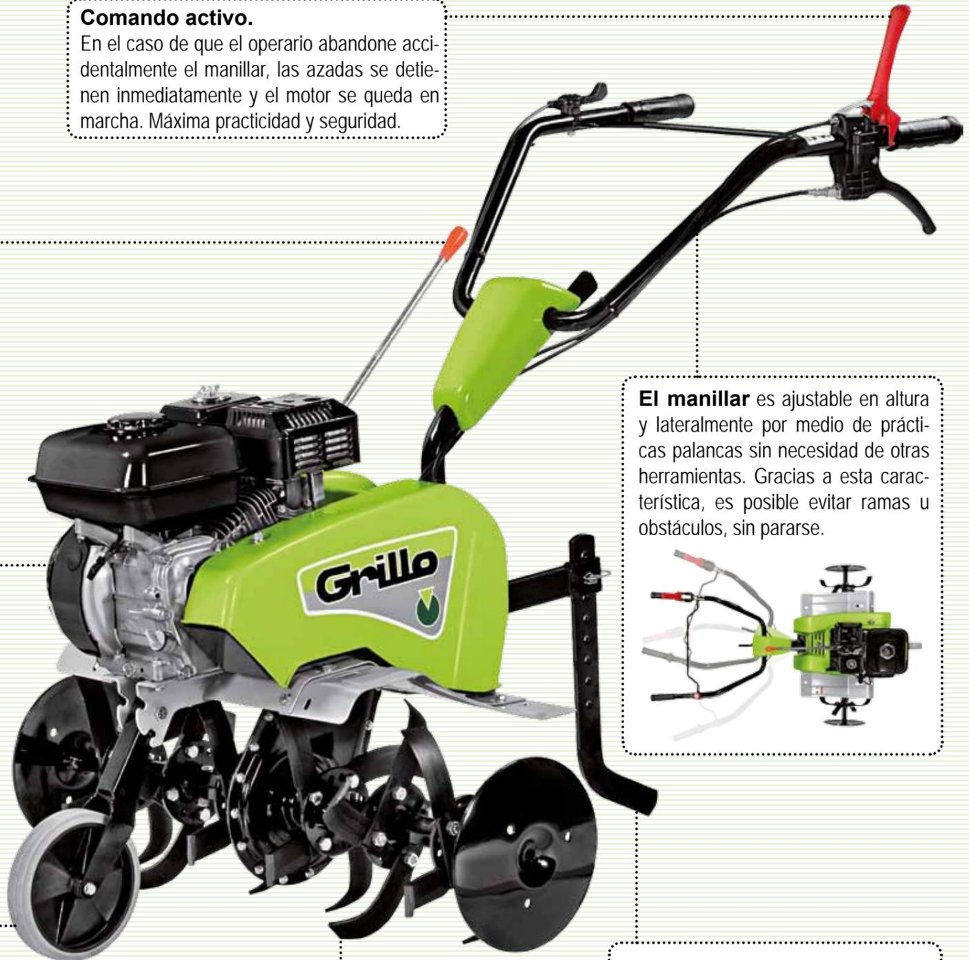
**La fresa** estándar mide 97 cm de ancho y permite una profundidad de arado hasta los 33 cm. Está compuesta por 6 estrellas de cuchillas con discos laterales. Las cuchillas de acero templado están aseguradas por medio de tornillos con tuercas. El eje de las cuchillas es **hexagonal** de 27 mm.
