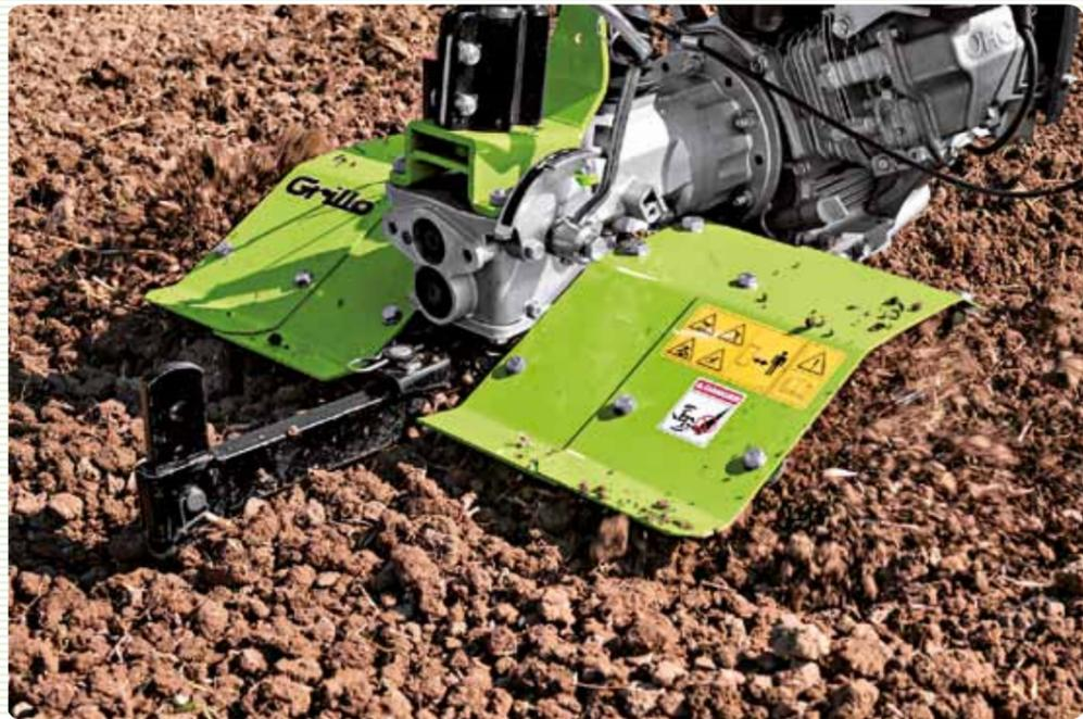
La motoazada Grillo está indicada para trabajar **en profundidad**, y en terrenos **muy duros y pedregosos**, también. La primera regla para labrar este tipo de suelo es la de mantener el espolón hacia delante, de modo que el operario, con poco esfuerzo, pueda maniobrar la máquina. Con una primera pasada se rompe la costra superficial y con la segunda se trabaja en profundidad.
