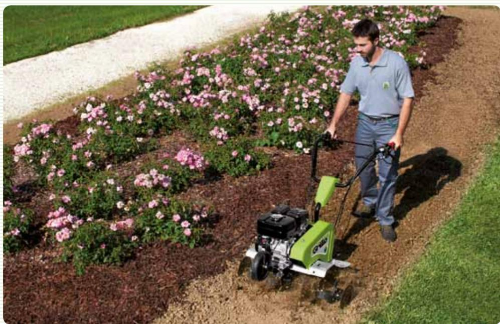
En presencia de un **terreno muy suave**, los discos laterales garantizan una buena flotabilidad y un avance uniforme de la máquina evitando el hundimiento.
