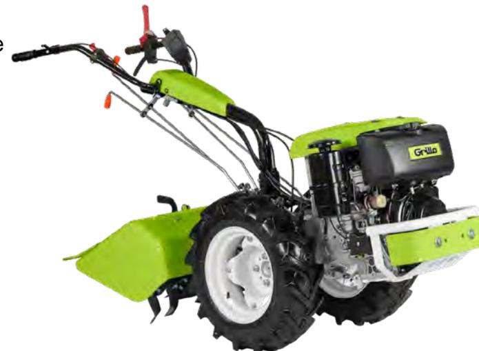
G 131 con motor diesel y fresa
