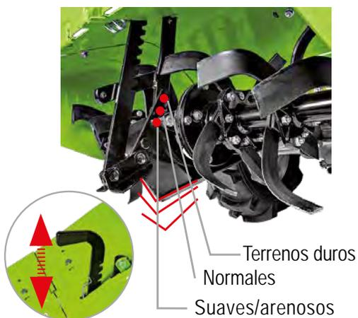
La **profundidad de fresado** se regula a través de una palanca colocada en el exterior del capó de la fresa. Para un resultado óptimo, es posible regular también la **cuchilla central** en 3 posiciones: para terrenos duros, normales y suaves/arenosos.
