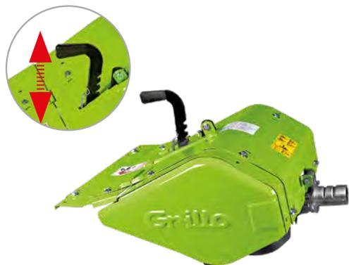
**La profundidad de fresado** se regula a través de una palanca colocada en el exterior del capó de la fresa. Para un resultado óptimo, es posible regular también la **cuchilla central** en 3 posiciones: para terrenos duros, normales y suaves/arenosos.
