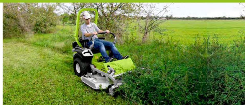
La versatilidad y la facilidad para cambiar de tipo de corte hacen del FX 27 un cortacésped apto para cualquier terreno. El plato de corte es accionado por un embrague electromagnético, está equipado de 3 cuchillas y tiene una anchura de trabajo de 125 cm.
