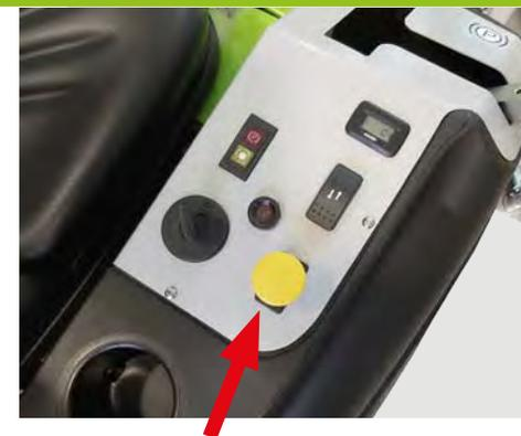
Embrague electromagnético para la conexión de las cuchillas.
