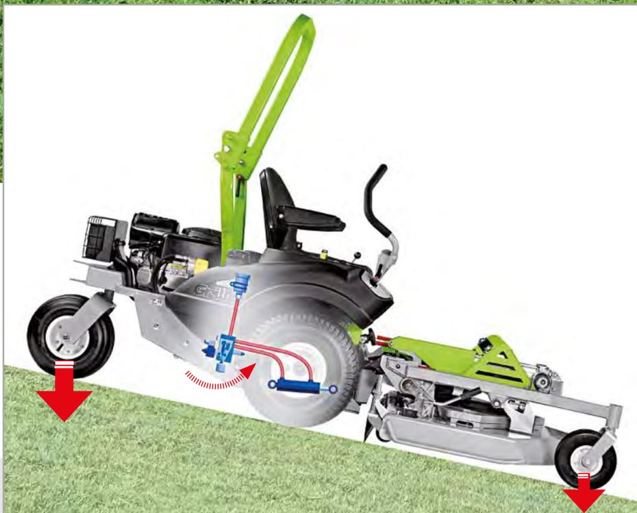
Otro de los puntos fuertes del **FX 27** es la dotación de un automatismo para la estabilidad y el balanceo a lo largo de las pendientes.
