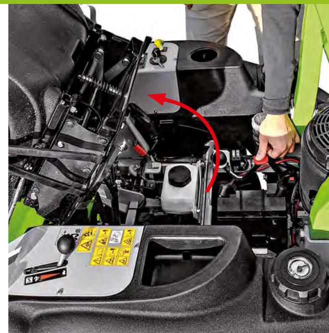
El asiento es abatible a través de un muelle amortiguador a gas, esto permite una fácil e inmediata inspección y mantenimiento de la máquina. Los puntos de engrase están indicados y fáciles de alcanzar.
