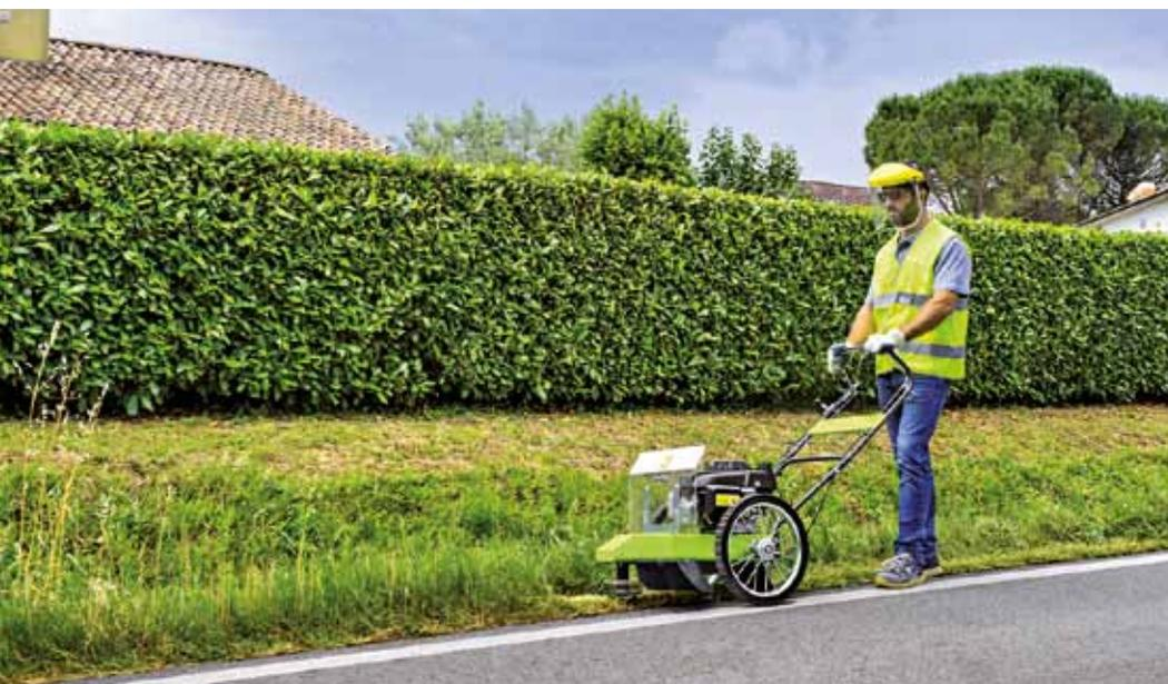
HWT 600 WD lleva un motor a gasolina de 4 tiempos, 166 cc (4.8 HP), la transmisión es con engranajes en baño de aceite y la correa de transmisión entre el motor y el rotor de corte es de alta resistencia para garantizar mayor duración.
