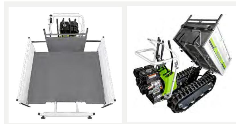
La plataforma de carga es extensible: los laterales y la puerta delantera se trasladan hacia afuera y se bloquean sin necesidad de herramienta específica.
