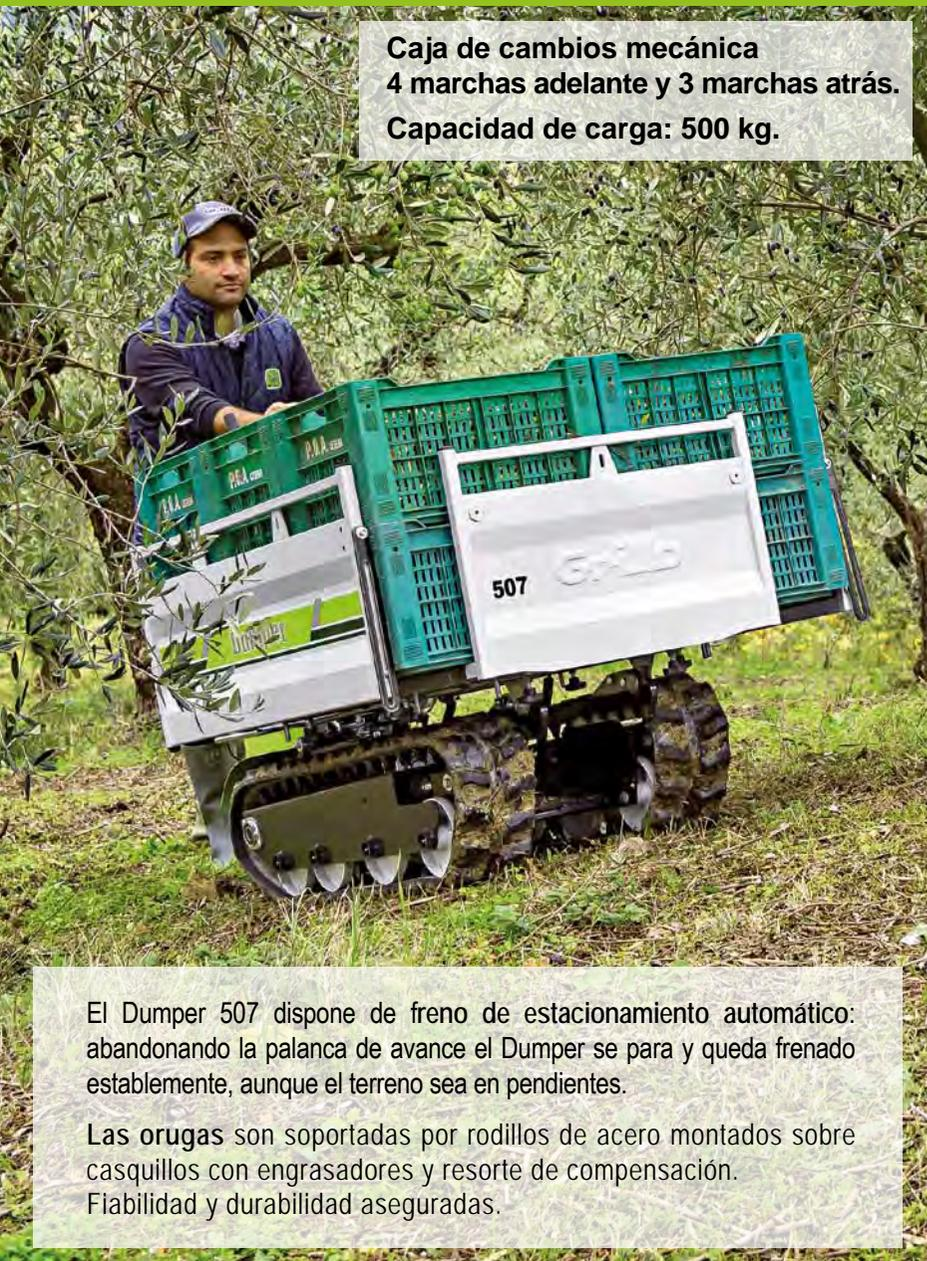
El Dumper 507 dispone de freno de estacionamiento automático: abandonando la palanca de avance el Dumper se para y queda frenado establemente, aunque el terreno sea en pendientes.
