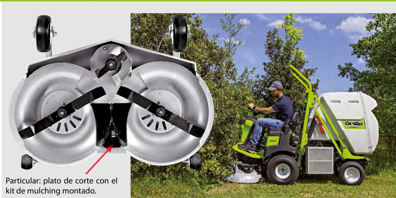
Particular: plato de corte con el kit de mulching montado.
